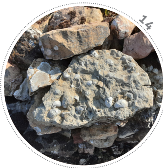
Moellon de calcaire à gryphées, ici bien visibles par leur forme arrondie au Champ Rocher
