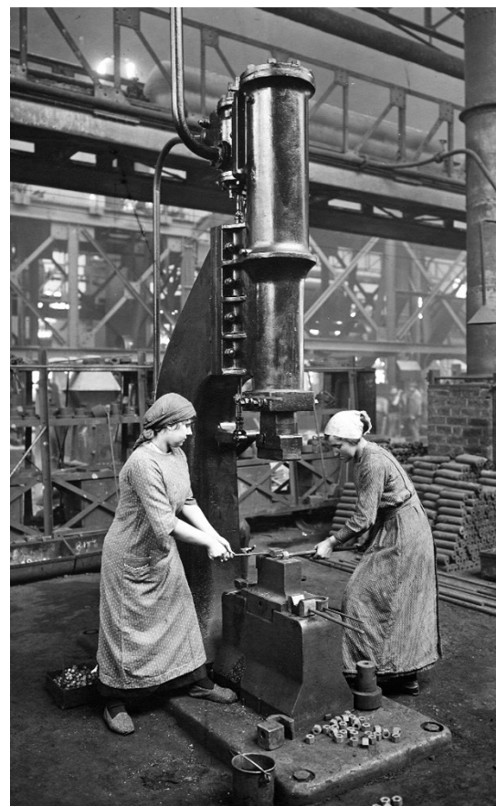
Image18. Femmes fabriquant des obus dans l'usine Schneider du Creusot (Saône-et-Loire) en 1916 à l'aide d'un marteau-pilon à vapeur. © Archives François-Bourdon, Le Creusot.
